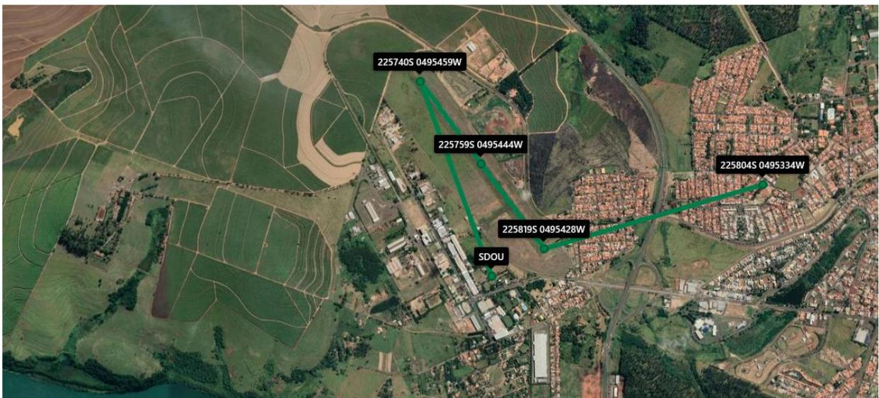
Os conjuntos de obstáculos à direita das pistas (16 e 34) são, aparentemente, constituídos pela ocupação urbana paralelamente ao longo da pista. Pode-se estimar que a faixa transversal livre da pista tem cerca de 375 m., com menor separação para linha de ocupação à direita da pista 34 (cerca de 95 m.).
