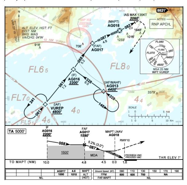
A carta prevê procedimento com dois IAF, um deles no fixo "VUREP" (a 18,4 MN no RM 070° para o aeródromo/ARP, ou 18,2 MN da cabeceira 10, para passagem à altitude mínima de 4.800 pés), outro no fixo/WYP AG013 (coordenadas 23°08'44,24"S/044°23"04,39"W, a 11,1 MN no RM 045° para o aeródromo/ARP, ou 10,9 MN no RM 044° para cabeceira 10, para passagem à altitude mínima de 4.400 pés), com órbita de entrada.
