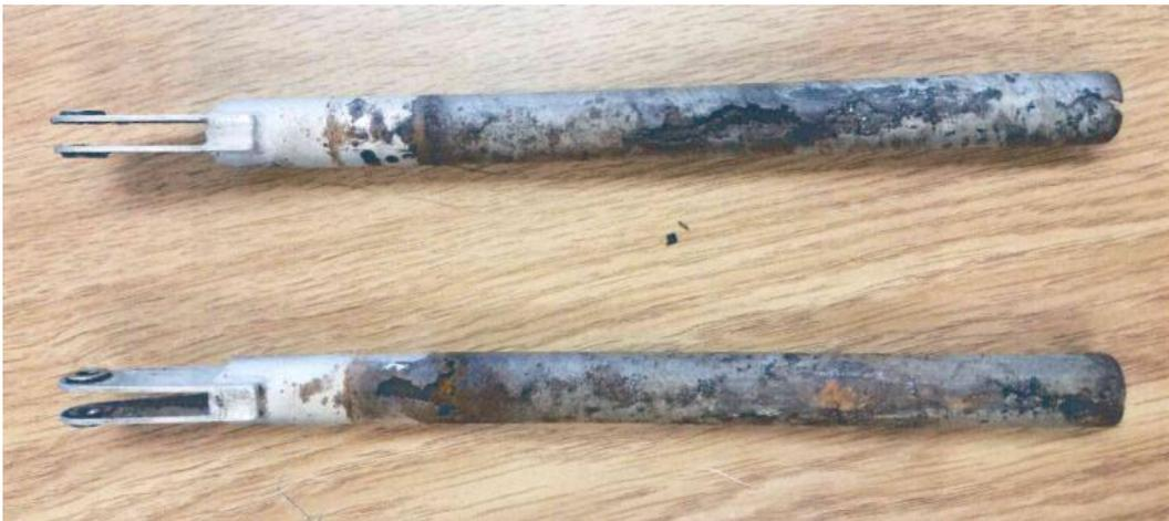
Não sendo os tubos (originais) substituídos, a corrosão poderá levar ao emperramento (travamento) dos tubos de balanceamento/equilíbrio que pode afetar o controle do profundor e/ou aileron. A Aerostar Aircraft Corp. considera o Boletim de Serviço de cumprimento mandatório, a partir do recebimento do documento da fabricante.
