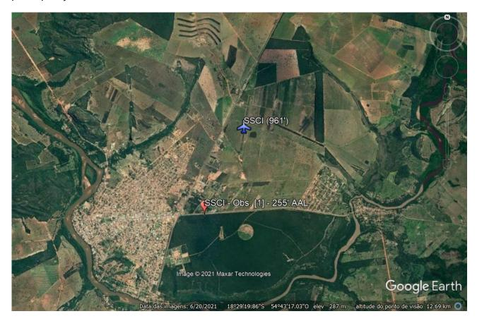
ROTAER informa a existência de obstáculo de aeródromo, de uma torre, com iluminação, com elevação de 1.261 pés (ie, 255 pés/78 m. AAL), com locação nas coordenadas 18°30'10,70"S/054°43'35,50"W, distando 1,4 MN do ARP (18°28'53"S/054°42'57"W) no RM 224°, e 1,3 MN da cabeceira 02 no RM 227 – a torre dista transversal do eixo prolongado cerca de 823 m., com o través a 1,22 MN da cabeceira 02.
