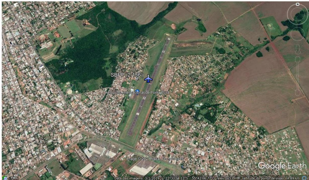
A operação VFR conta com carta VAC (com entrada pelo setor leste, para tráfego à 1.000 pés AGL, com perna-do-vento pela esquerda para pista 22 e pela direita para pista 04).
