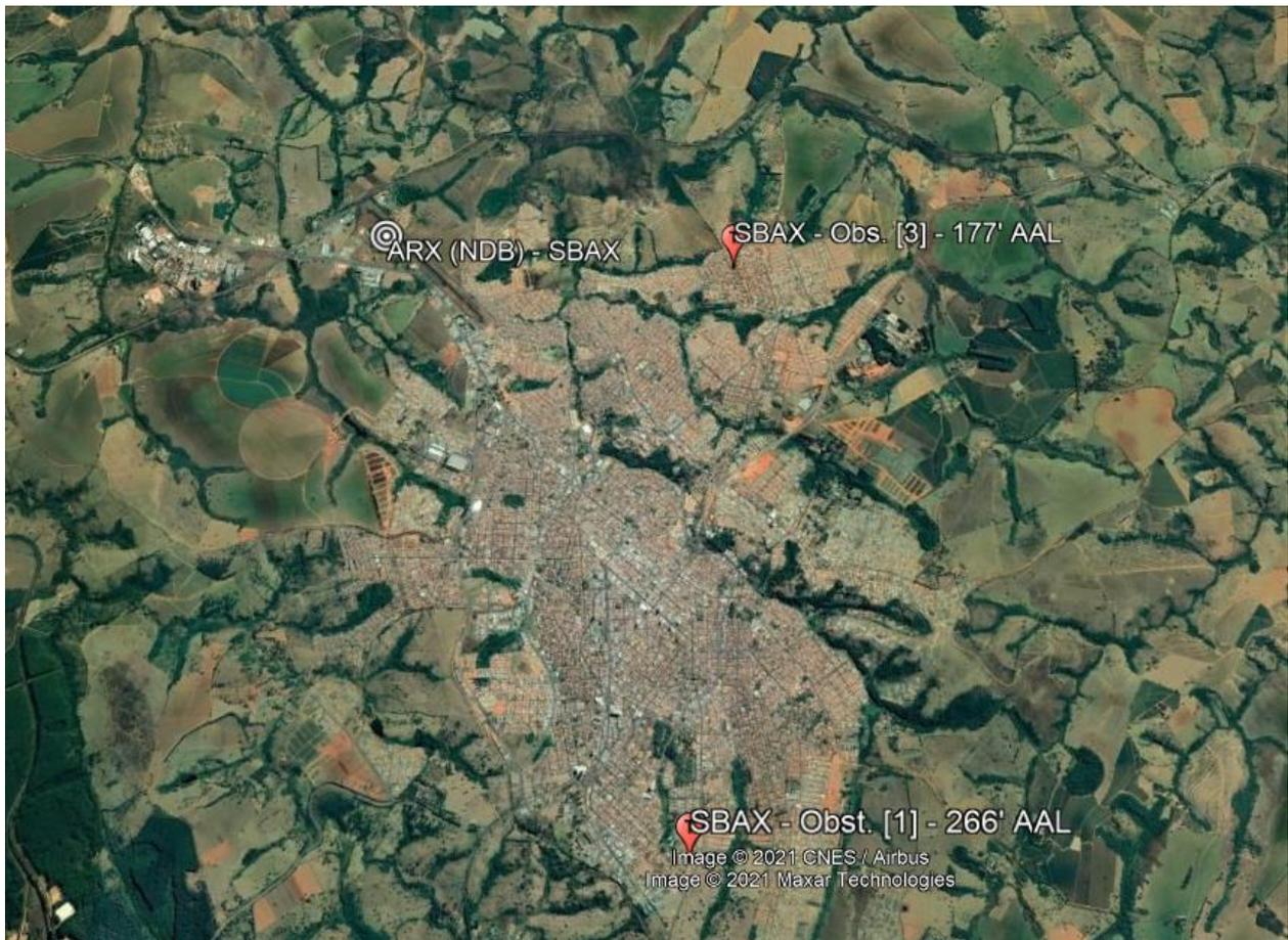
[3] a torre do rádio-auxílio NDB “ARX” (instalado no sítio), com elevação de 3.388 pés (ie, 110 pés/33,5 m. AAL), situada a 17º à direita do início do eixo da pista 16 à distância de 490 m. (coord. 19°33'39,60”S/046°57'52,80”W).
