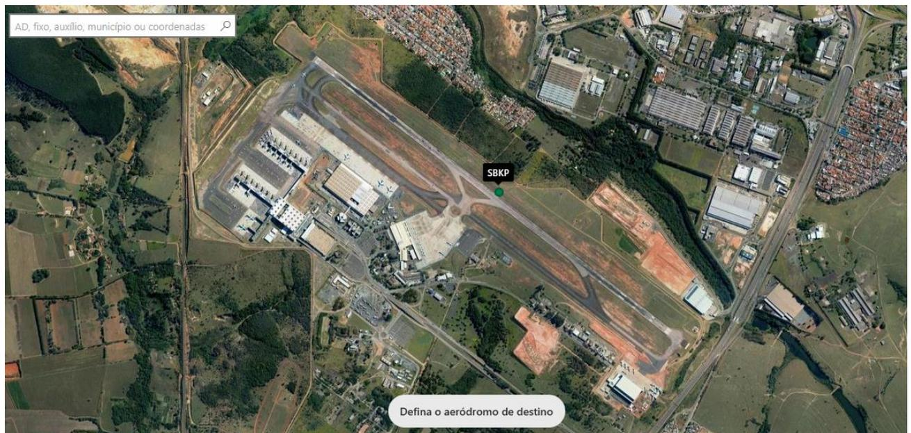
Conforme carta de aeródromo (ADC), a pista (de 45 x 3.240 m.) conta com áreas livres (CWY) de 280 x 150 m., com faixa preparada sendo de 280 x 3.360 m.
