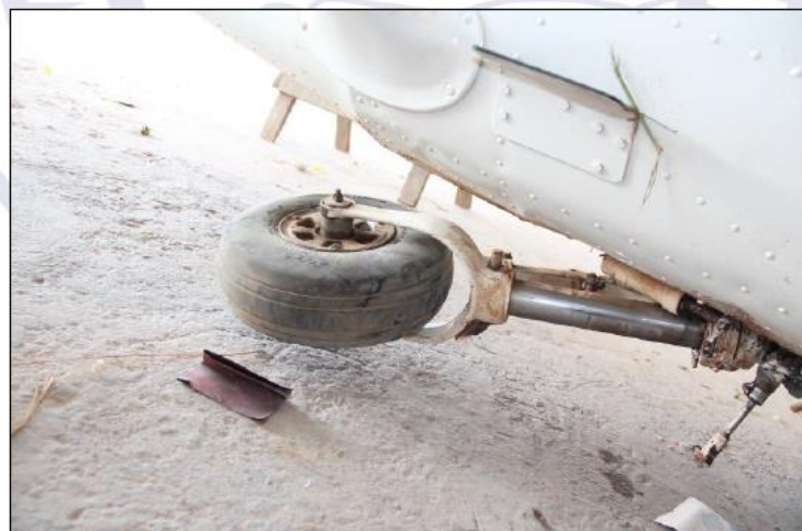
Figura 7 - Trem de pouso do nariz fraturado.
