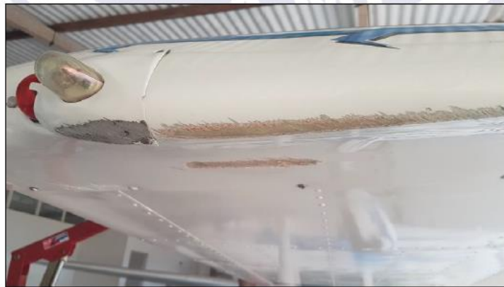
Figura 3 - Danos na ponta da asa esquerda da aeronave.
