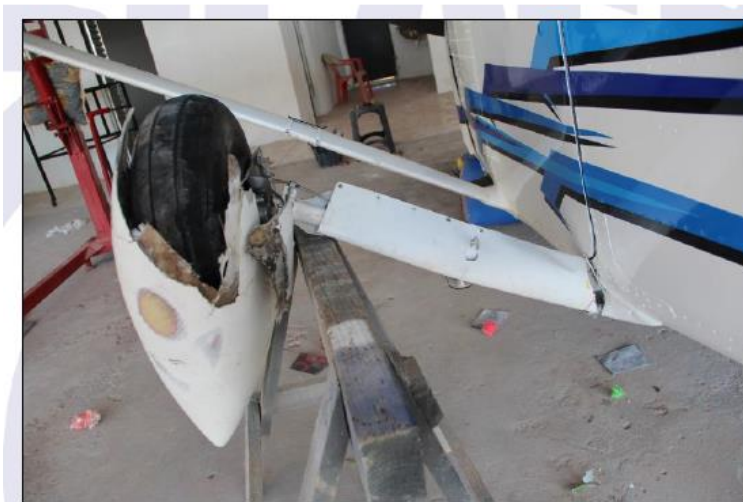
Figura 6 - Trem de pouso principal esquerdo fraturado.
