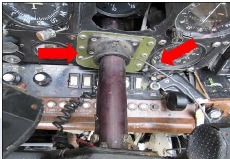
Figura 5 - Vista do arame utilizado como trava do manche do PT-OBU, na posição em que foi encontrado pela Comissão de Investigação.
