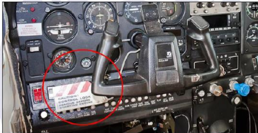
Figura 4 - Modelo de trava do manche prevista para o Cessna R182.
