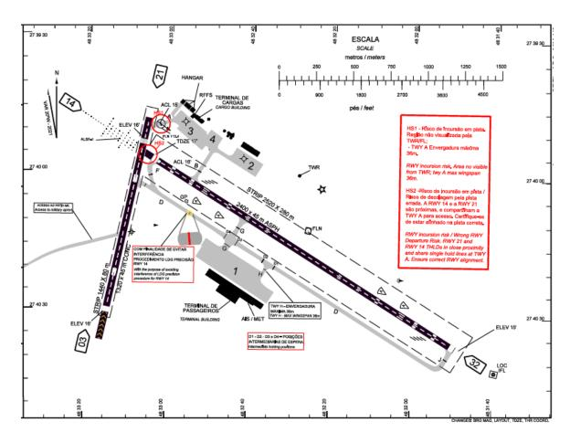
A pista 14/32 é dotada de sistemas de luzes de indicação de rampa de aproximação PAPI nas duas cabeceiras – com inclinação de rampa de 3º, com MEHT de 50 pés na cabeceira 14 e de 63 pés na cabeceira 32. Adicionalmente, a cabeceira 14 conta com sistema de luzes de aproximação (ALS) – do tipo ALSF-1 (ALS CAT.I com *flash*), de 720 m -, ora fora de serviço (cf. NOTAM E3495/22R-E3494/22).
