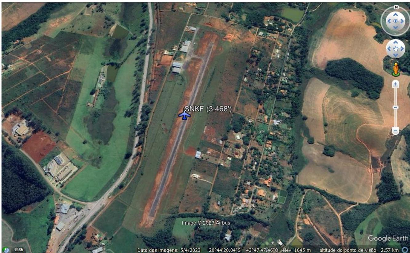
ROTAER informa a existência de “Obstáculo de Aeródromo” de um poste com elevação de 1.136 m. (3.727 pés, equivalente a 259 pés AAL) com locação à distância de 3.600 m. (1,94 MN) da cabeceira 04 no Azimute 199°. O obstáculo tem separação transversalmente ao eixo estendido da pista de 313 m., o través do obstáculo no eixo estendido distando 1,93 MN (3,58 km) da cabeceira 04.
