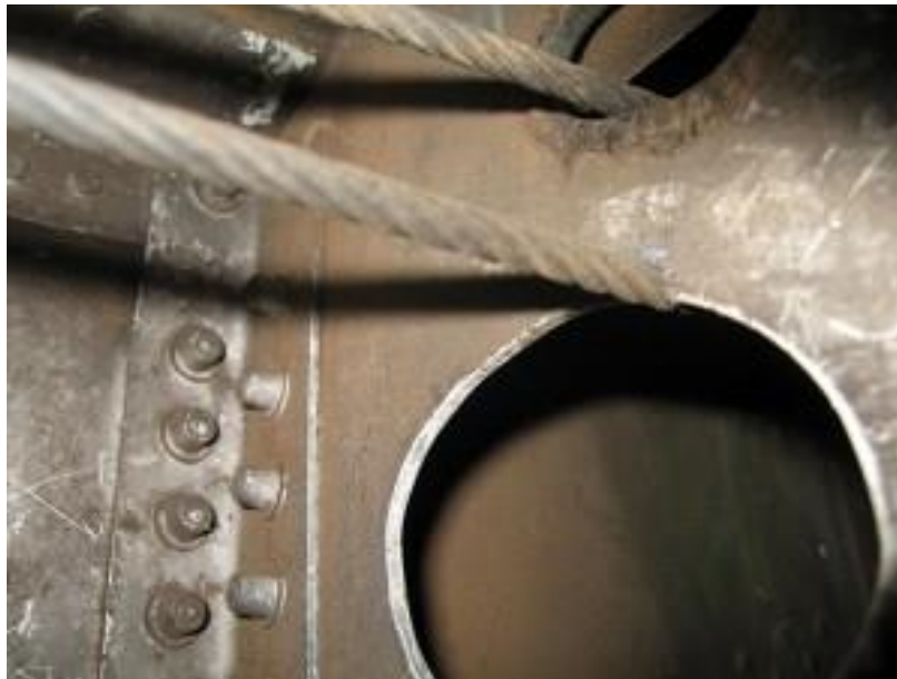
Detalhe de cabo do aileron cortando nervura da asa
