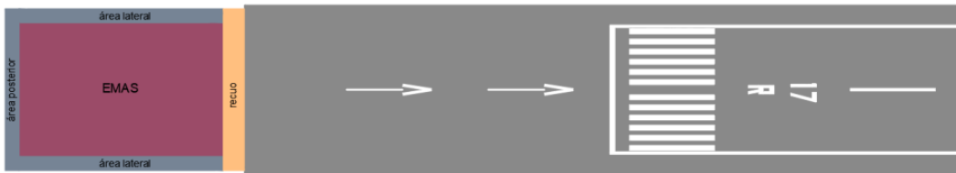
Figura 1 – Representação do EMAS da Cabeceira 17R
