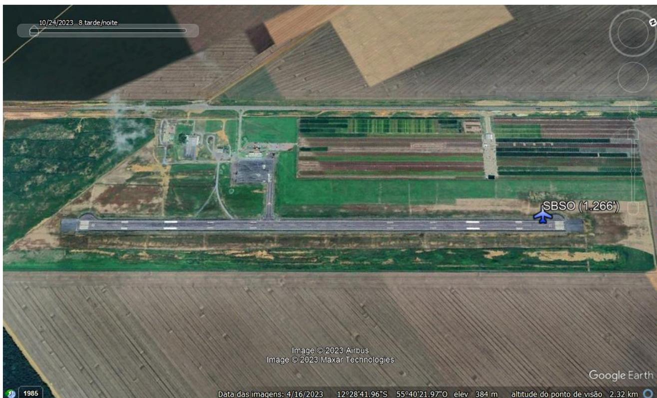
Conforme Carta de Aeródromo (ADC), a pista (05/23) tem rumo RM  $047^{\circ}/227^{\circ}$  – RV  $028^{\circ}/208^{\circ}$  -, a cabeceira 05 está em elevação de 1.244 pés (-22 pés/6,7 m. AAL) e a cabeceira 23 na elevação 1.263 pés (-3 pés AAL, e +19 pés/5,8 m. da cabeceira 07), com área de giro de aeronaves em ambas extremidades da pista.
