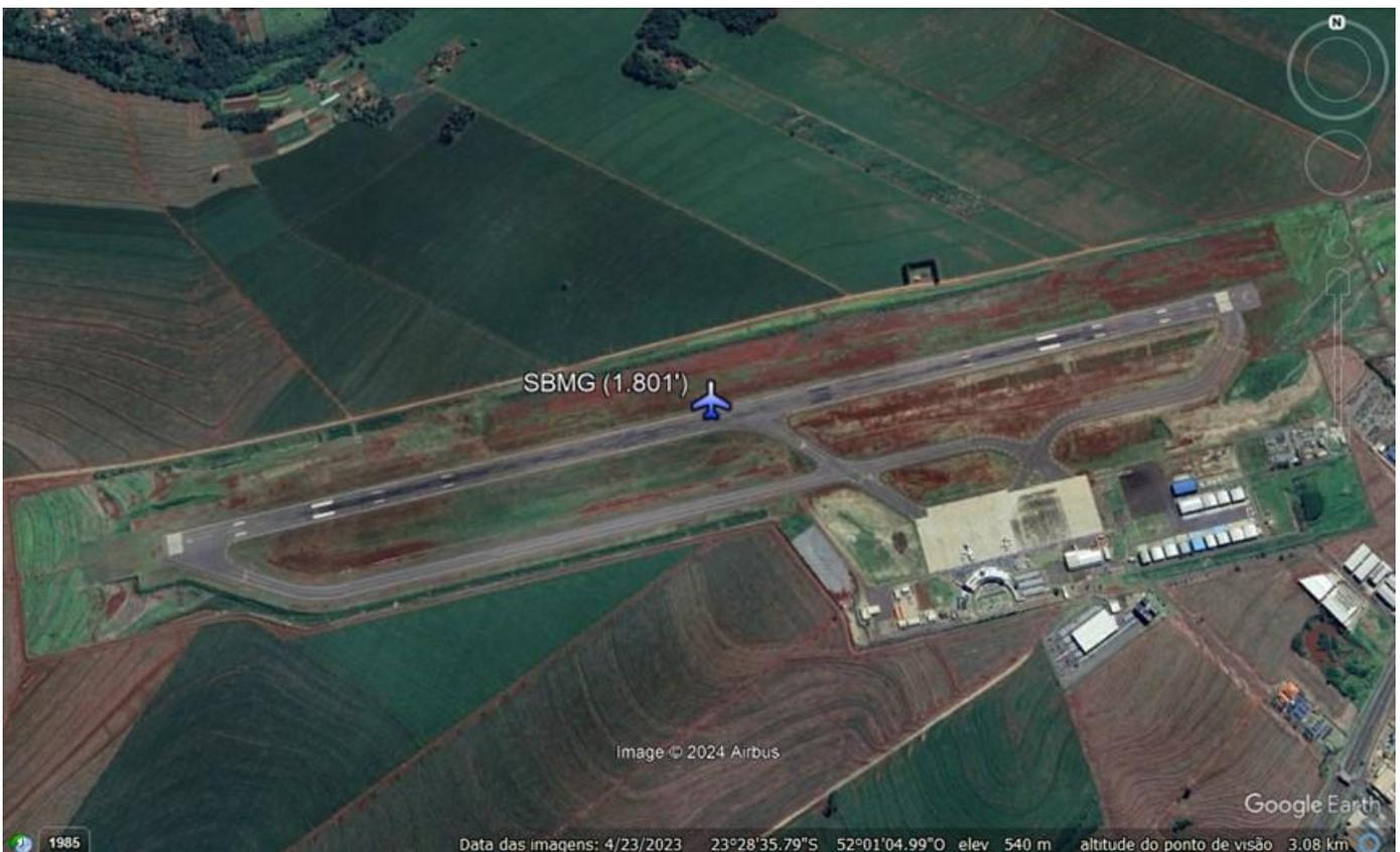
A cabeceira 10 conta com sistema de luzes de indicação de rampa de aproximação de precisão PAPI com rampa de 3° para MEHT de 50 pés e sistema de luzes de aproximação com flash (ALSF) categoria 1 (ALSF-1). O sistema de luzes de pista conta com as luzes de cabeceira e luzes laterais (de bordo) longo da pista a cada 60 m., e mais as luzes de *taxiway*. A faixa de pista tem dimensões de 280 [45+235] x 2.500 m. [2.380+2x60].
