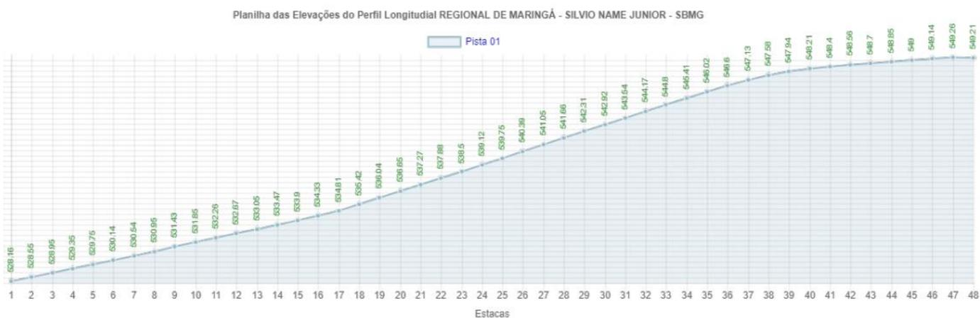
O perfil é de pista 10 em acive (*upslope*), podendo-se considerar um primeiro segmento a partir da cabeceira 10, entre estacas #1 e #17 (800 m.), com desnível de 6,65 m. (21,8 pés), com uma inclinação de 0,83%, e segundo segmento sequente, entre estacas #17 e #38 (1.050 m.), com desnível de 12,77 m. (21,8 pés), com uma inclinação de 1,22%; uma inclinação ponderada para este trecho (de 1.850 m., cerca de 79% do comprimento de 2.350 m.) de 1,05%.
