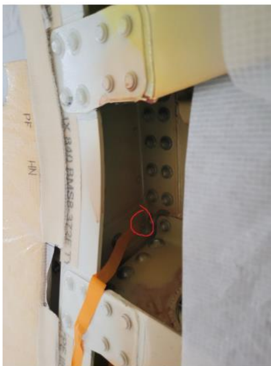
Fig. 14 - Foto-detalle de um rebite danificado Reprodução relatório preliminar (DCA24MA063)
