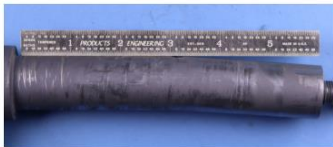
Fig. 12 – Encaixe articulado ( hinge fitting ) lado traseira desmontado mostrando tubo ( shaft ) deformado (fletido) Reprodução relatório preliminar (DCA24MA063)
