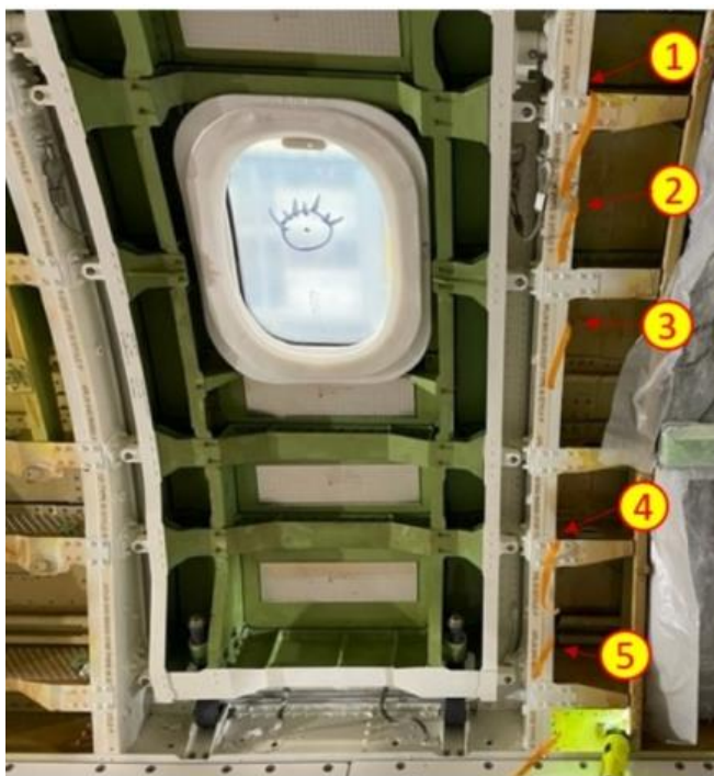
Fig. 14 - foto mostrando cinco pontos de locação dos (5) rebites danificados Reprodução relatório preliminar (DCA24MA063)
