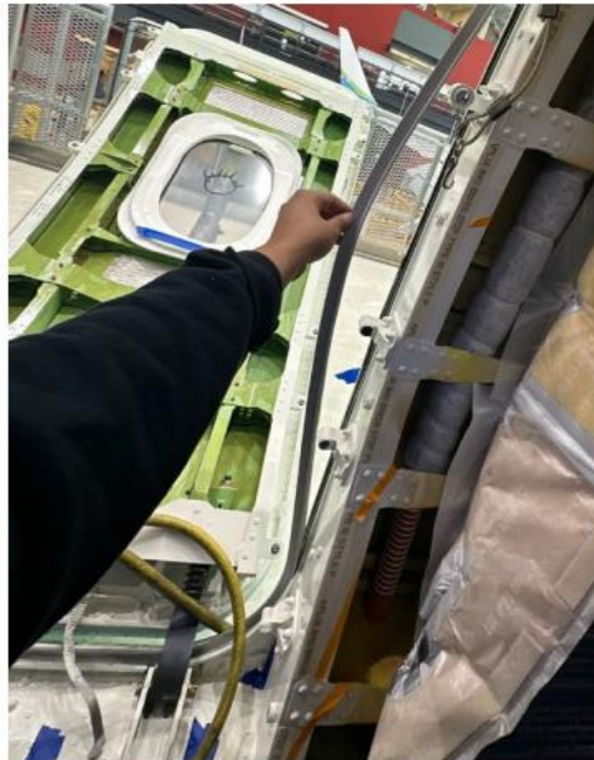
Foto mostrando o plugue MED aberto para trabalho nos rebites danificados Reprodução relatório preliminar (DCA24MA063)
