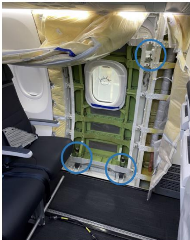
Foto mostrando o plugue MED esquerdo imediatamente antes da restauração interna
