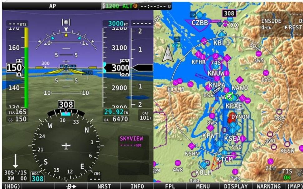
Barra de *status* do PA (topo - lado esquerdo da tela) - “AP” em luz branca indicando que o PA não está acoplado
