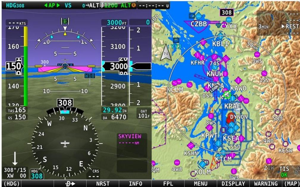
Barra de *status* do PA (topo - lado esquerdo da tela) - “AP” em luz verde (entre setas) indicando que o PA está acoplado
