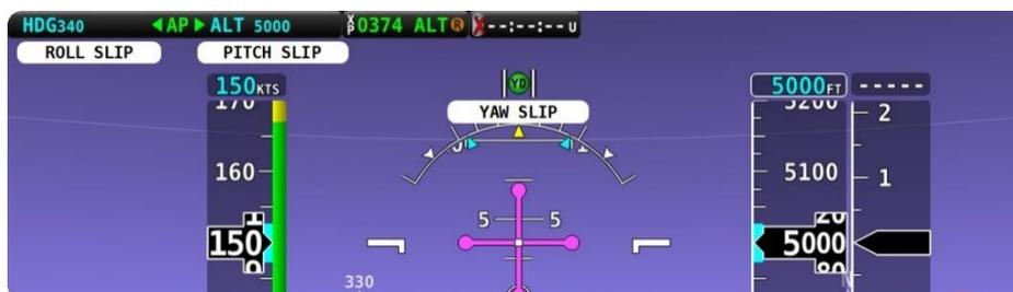
Servo-deslizamentos são esperados de tempo em tempo e não se tratando de evento como ruptura do parafuso de cisalhamento conforme descrito anteriormente. Os servo-deslizamentos são geralmente transitórios e geralmente ocorrem quando as cargas de controle são aumentadas em:
