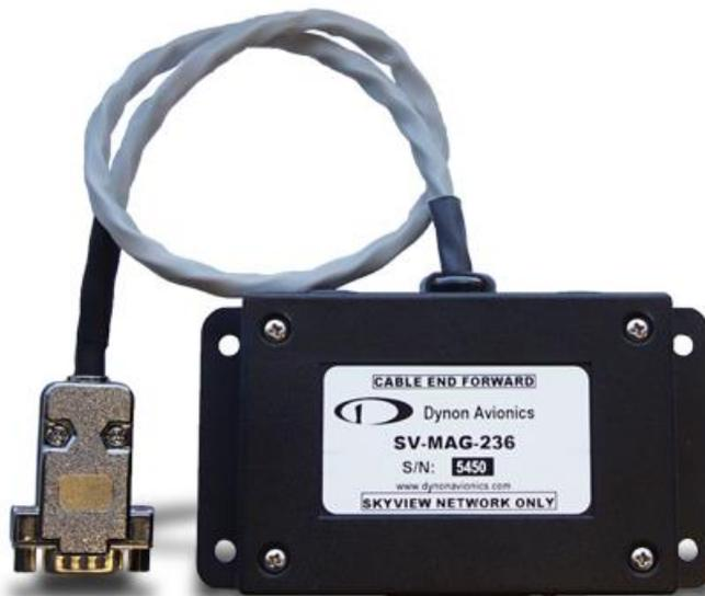
Para minimização de interferência de outros equipamentos que obscurecem o campo magnético da Terra, os sensores do magnetômetro devem estar localizados longe de outros dispositivos elétricos, fiação elétrica e metais ferrosos - especialmente metais ferrosos que se movem. Este módulo é montado remotamente em uma área do avião que o separa desses distúrbios magnéticos. As
