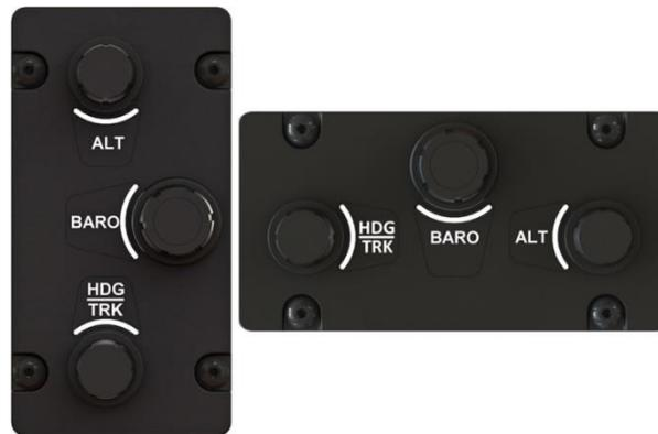
Este painel oferece acesso direto aos botões usados para selecionar rumo (HDG) ou rota (TRK) desejado para o piloto-automático manter, bem como a altitude (ALT) para o piloto-automático capturar e manter. O terceiro botão, BARO, permite ajustar diretamente a configuração de altímetro, assim como faria em um altímetro mecânico sensível à pressão atmosférica.
