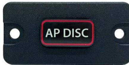
Recomenda-se que um botão seja montado no manche para ser usado para desconectar o piloto-automático. Se isso não for possível, o botão de desconexão do piloto automático poderá executar esta função. Pelo menos um botão de desconexão do piloto-automático de algum formato deve ser instalado.
