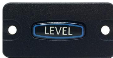
Pressionar o botão LEVEL (ou modo reto-nivelado - *Straight e Level Mode*) comandará imediatamente o piloto-automático para um *pitch* para resultar velocidade vertical zero e para um rolamento para zero grau de inclinação. A função não comandará o avião para qualquer altitude, rumo ou trajetória anterior e não respeitará nenhuma entrada por *bug*. A função manterá as atitudes de *pitch* em nível e rolamento, no rumo e na altitude em que houve a recuperação de atitude.
