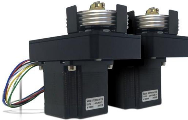
Uma caixa leve de alumínio abriga um trem de engrenagens de aço inoxidável para otimizar o peso sem sacrificar a resistência. O ‘braço’ de controle do servo é capturado por uma porca acastelada e preso por contrapino, assim como outras interfaces críticas de aeronave.
