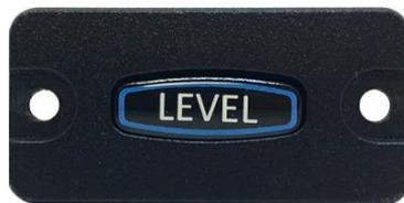
Pressionar o botão LEVEL (ou modo reto-nivelado - *Straight e Level Mode*) comandará imediatamente o piloto-automático para um *pitch* para resultar velocidade vertical zero e para um rolamento para zero grau de inclinação. A função não comandará o avião para qualquer altitude, rumo ou trajetória anterior e não respeitará nenhuma entrada por *bug*. A função manterá as atitudes de *pitch* em nível e rolamento, no rumo e na altitude em que houve a recuperação de atitude.
