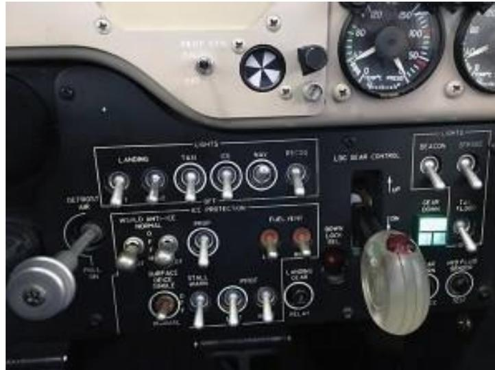
Fig. 4: subpainel (painel inferior) piloto (PIC) - à direita (*Pilot's righthand subpanel*) de um "350"
