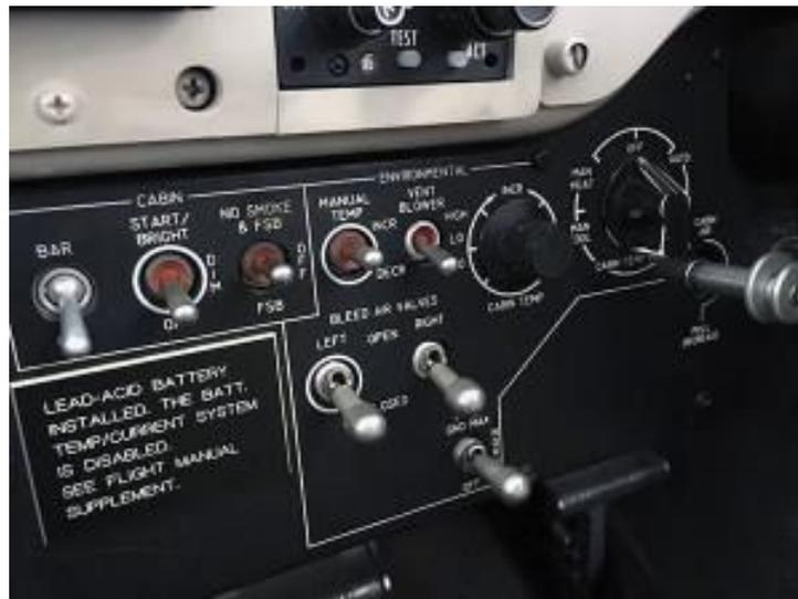
Fig. 6: subpainel (painel inferior) esquerdo (posto copiloto) (*Leftsubpanel*) do modelo 350
